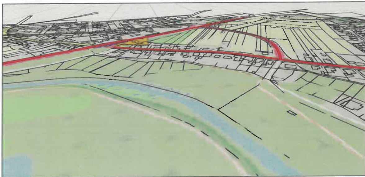
Abbildung 3: 3D-Ansicht aus dem Schallausbreitungsmodell zur Verdeutlichung der erhöhten Lage der Bundesstraße B 213.
